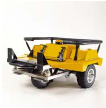
Figura 2: il dispositivo per il rilievo dell’aderenza denominato “GRIPTESTER”
