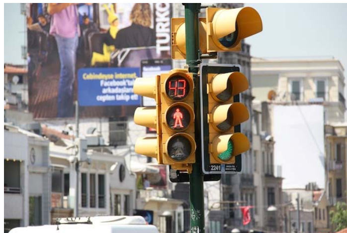
Istanbul: Timer con countdown per la fase di rosso (attraversamento pedonale n. 2)
